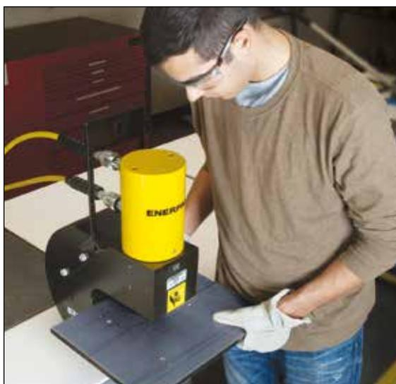
▼ Abgebildet ist das 50 t Lochstanzgerät mit montiertem Fußbefestigungssatz SP120 und Tiefenanschlag SP110.
